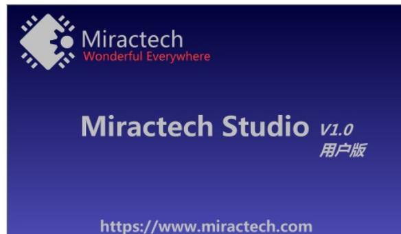
软件启动界面，该启动界面可以替换成用户自己需要的启动界面，替换文件在程序根目录下logo.bmp图片，图片尺寸为480\*280像素，启动界面中的图片必须为bmp格式否则将无法显示图片。
